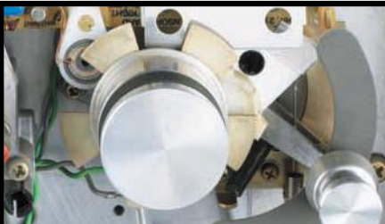
Bandbewegungsmelder (Mitte) und Bandzug-Fühlhebel (rechts) bei der A 700 arbeiteten dank induktiver Kopplung verschleißfrei.
