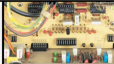
Die Basisplatine der A 700 wirkt durch den Einsatz integrierter Schaltungen aufgeräumt. Rechts unten der Vorverstärker für den Phono-MM-Eingang.
